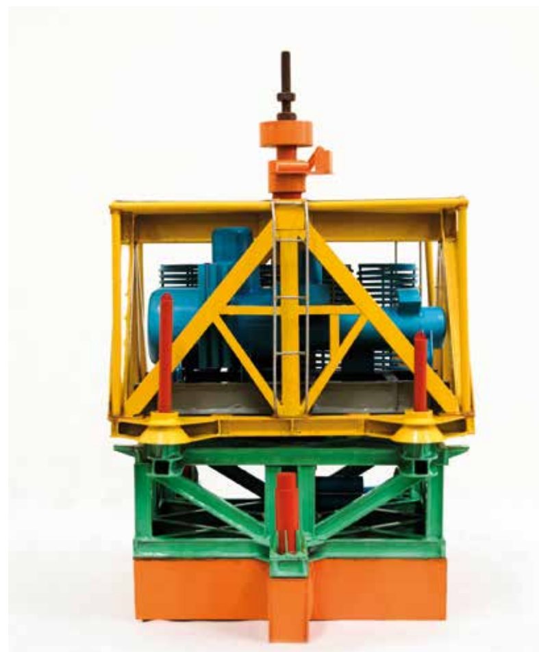
Maquete de módulo submarino de uma plataforma marítima utilizada em ensaios no tanque de provas do IPT.
