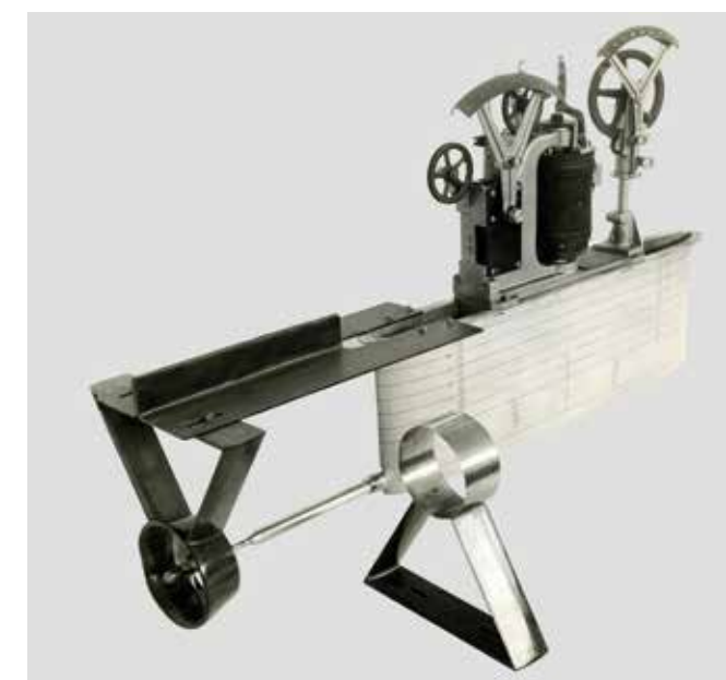
José Fernandes de Oliveira, técnico da Seção de Madeiras, em estudo de identificação botânica; e duas imagens do dinamômetro, utilizado pela Seção de Engenharia Naval para ensaios de água aberta com modelos de hélices de navios, equipamento fabricado pela Kempf & Remmers e adaptado pelo IPT.
