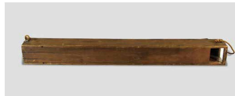
A partir do alto, moldes para granadas, munição 75mm TR, bocal lança-granadas e periscópio de madeira com dois espelhos, um em cada extremidade, posicionados de forma transversal: peças fabricadas no LEM e utilizadas na Revolução Constitucionalista de 1932.
